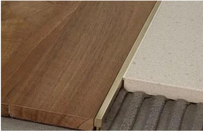
铜条也可以用在卫生间，但防水性不及过门石，所以只能用在干湿分离的卫生间门口。这种铜条一般是 L 型，安装完成后要比卫生间地砖高 0.5`1cm，防止水溢出去。
